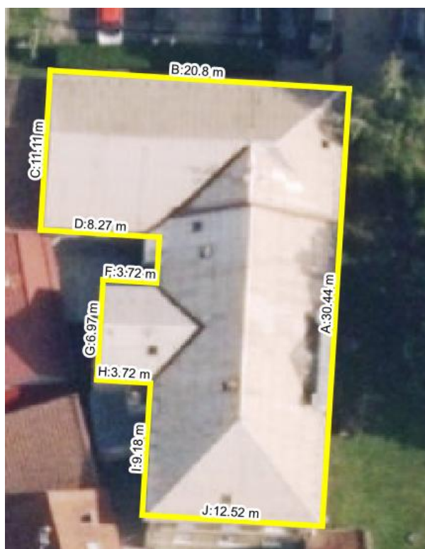
Obrázek 14: Okótovaná střecha objektu – ZŠ Mostkovice 243
