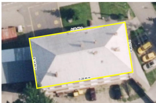
Obrázek 13: Okótovaná střecha objektu – Obecní úřad 197
